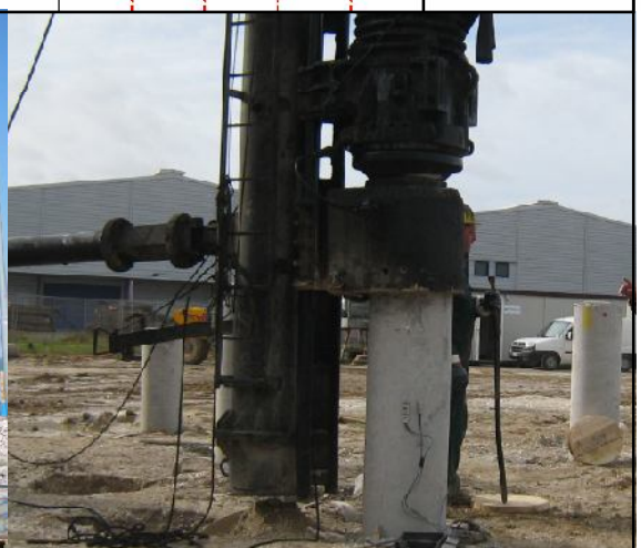
Dinamični obremenilni test na zabitem pilotu
